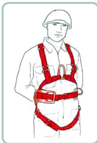
Figura 15: imbracatura per il corpo con cintura di posizionamento integrata ed attacco sternale.
