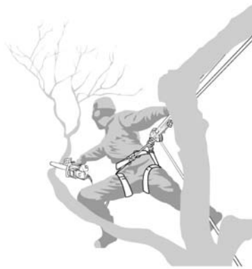
Fig. 2 – Caso d'uso della motosega con una sola mano (tratto dal draft amendment ISO 11681-2: 1998/DAM1)
