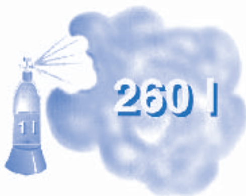
Figura 2.4: Anche piccole quantità di liquidi infiammabili possono, evaporando, causare una massiccia quantità di vapori infiammabili (ad esempio, propano liquefatto).
