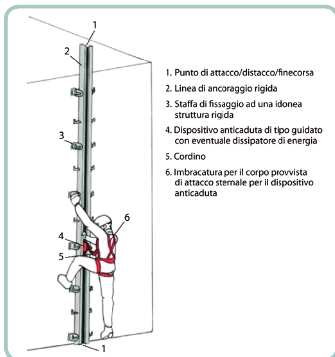
Figura 3: esempio di sistema di arresto caduta costituito da imbracatura per il corpo collegata con cordino corto al dispositivo anticaduta su una linea di ancoraggio rigida per salite lungo pali, scale e tralicci.
